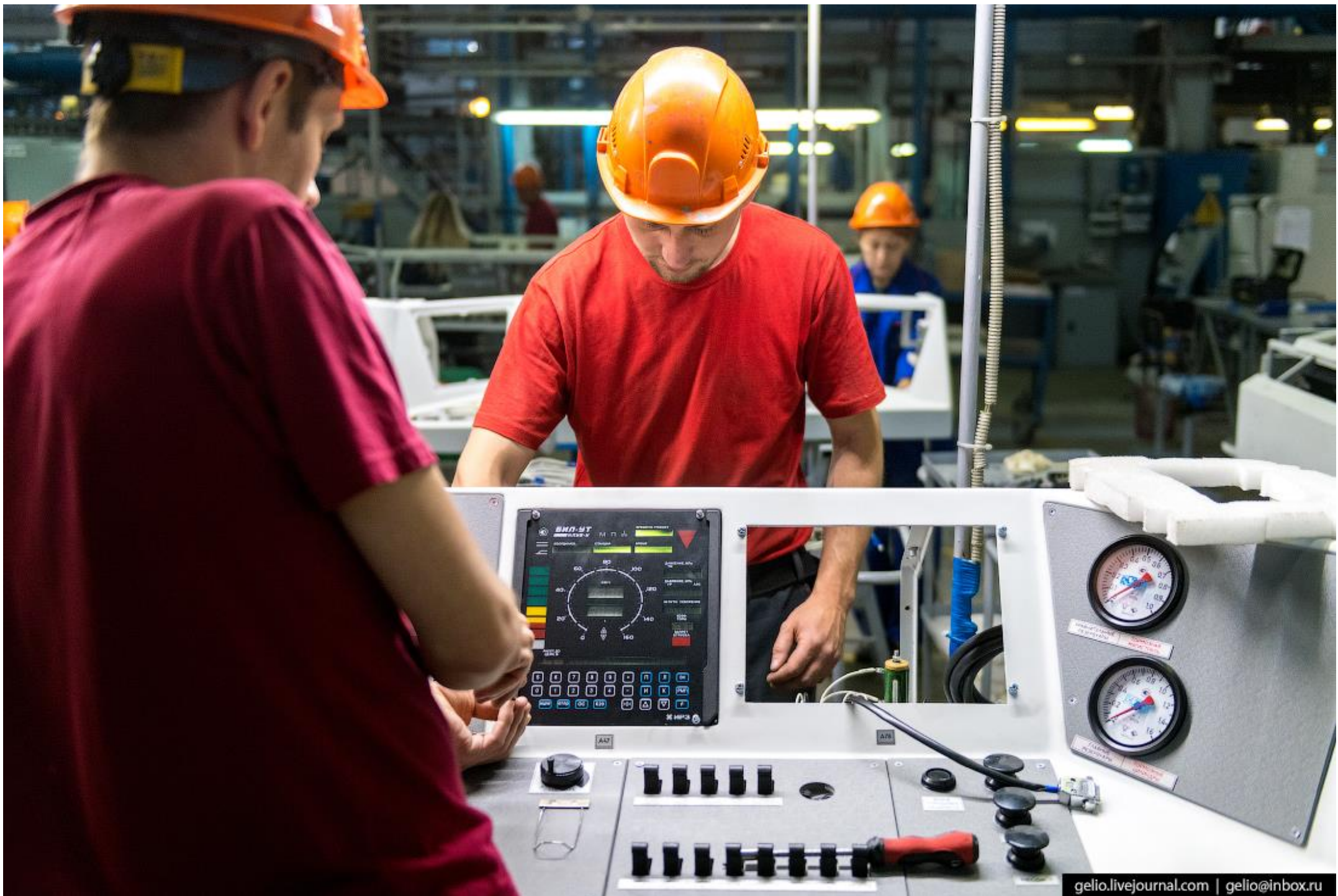
Работники экспериментально-аппаратного цеха монтируют пульт машиниста.
