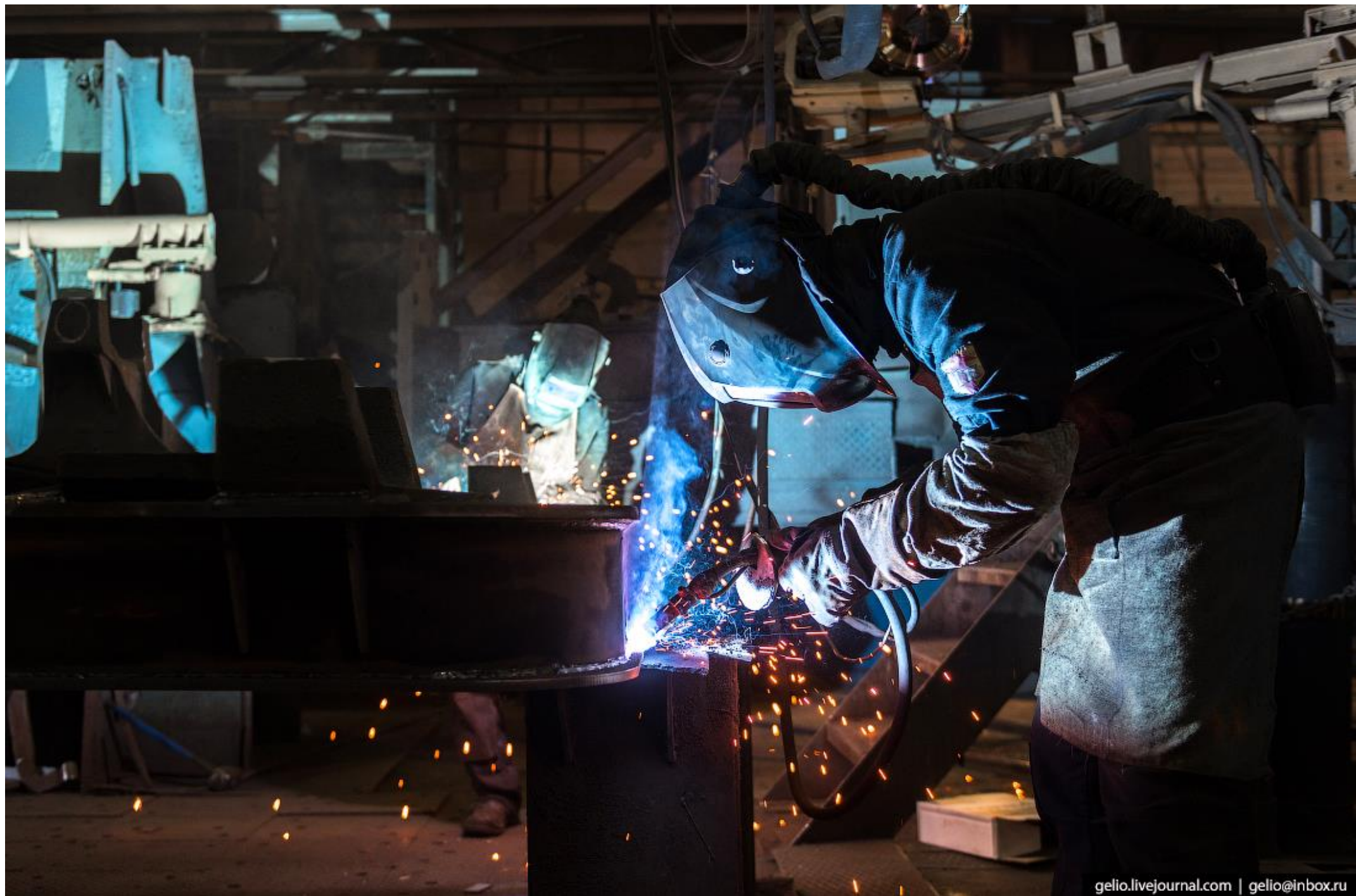
Сварочно-кузовное производство. Сварщики работают над тележкой будущего грузового электровоза
