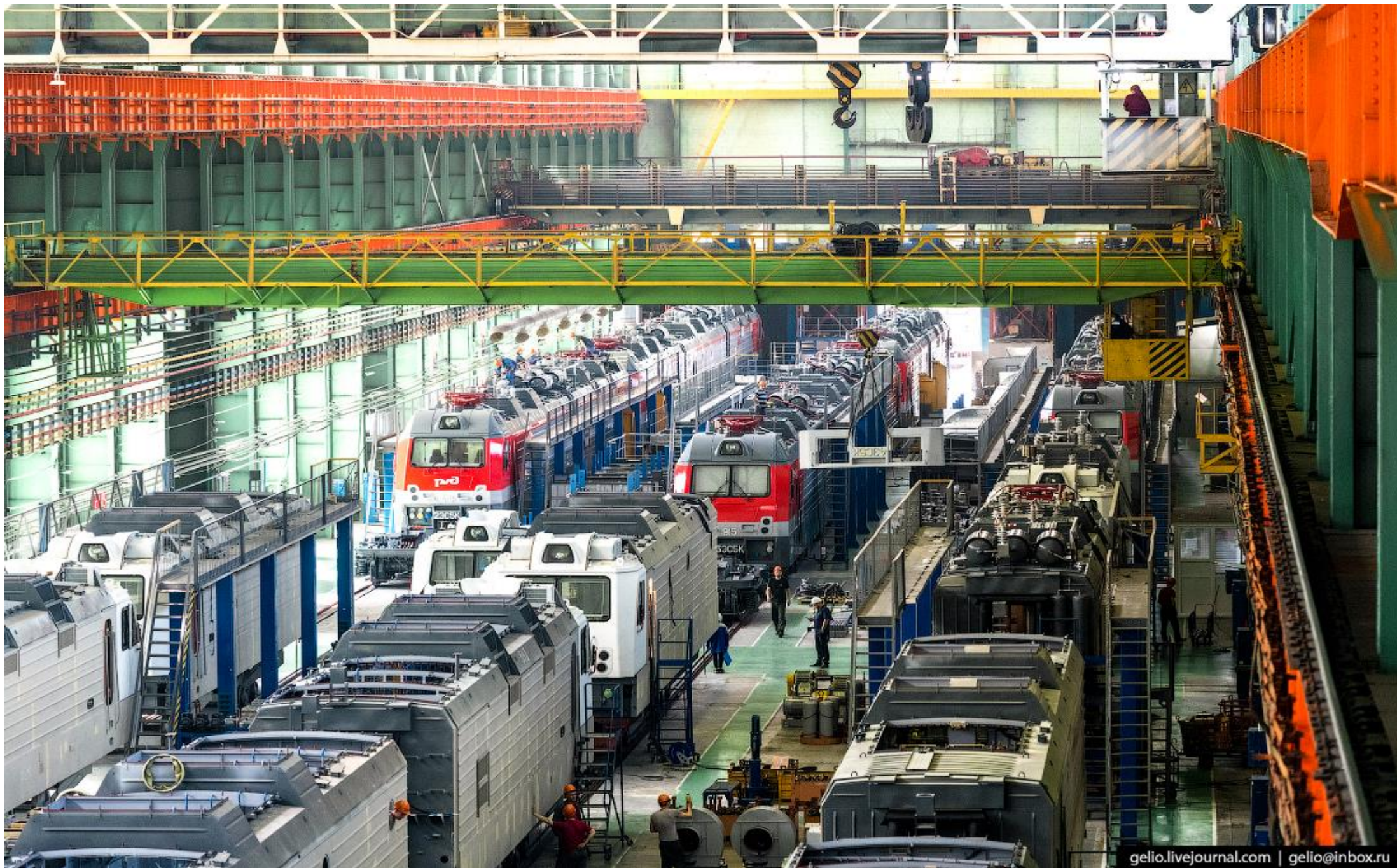
Сборка серийных грузовых электровозов переменного тока. В цехе параллельно собирают несколько электровозов разных типов. Сборка одного локомотива занимает в среднем 30 дней.
