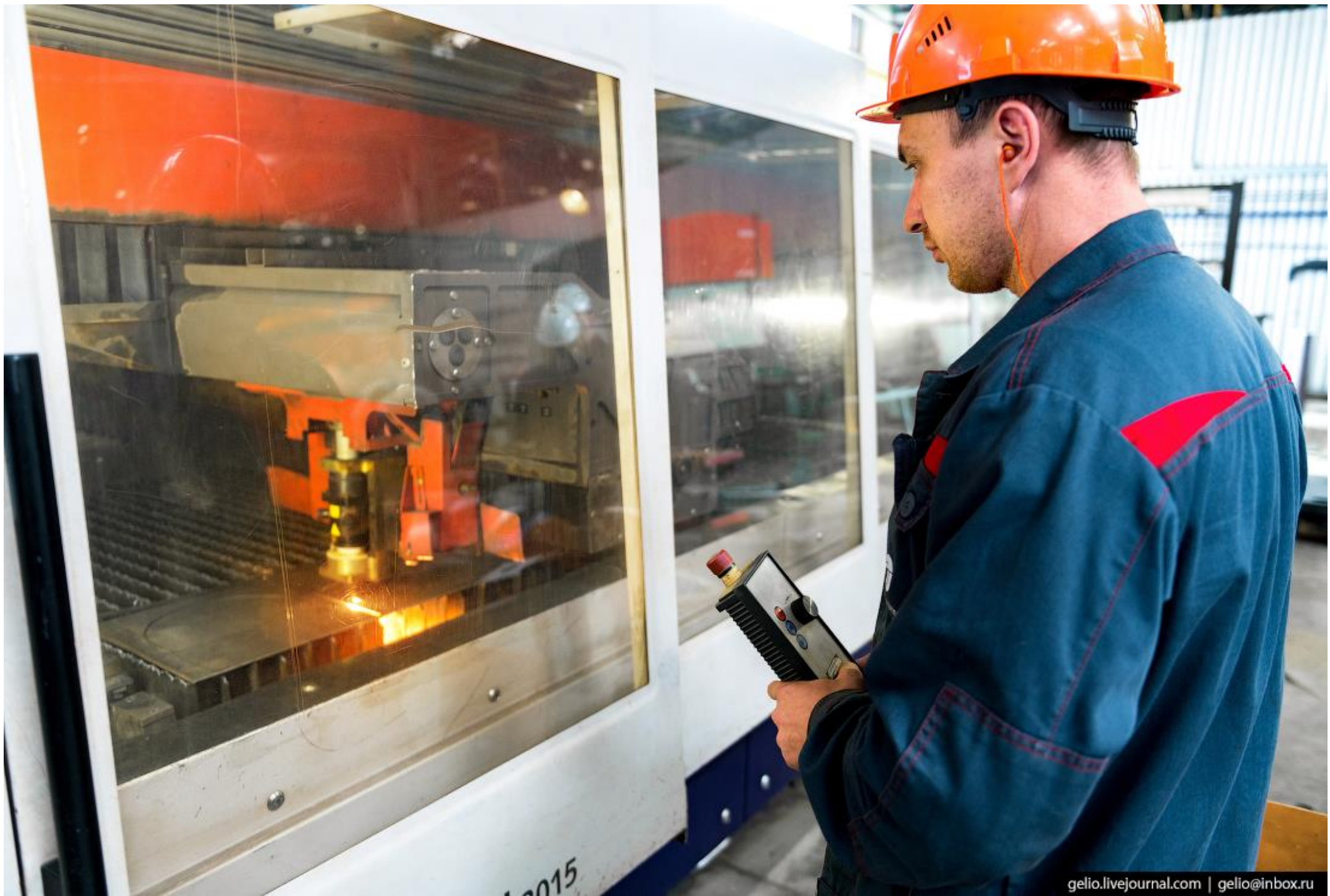
Газорезчик следит за тем, как проходит раскрой металла
