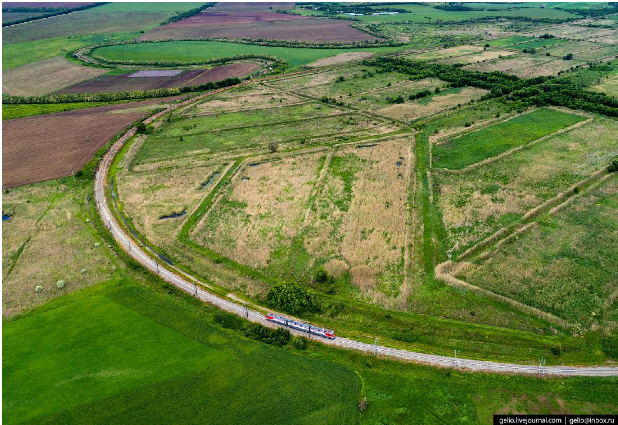
После сборки электровозы проходят испытания на обкатном кольце НЭВЗа.
