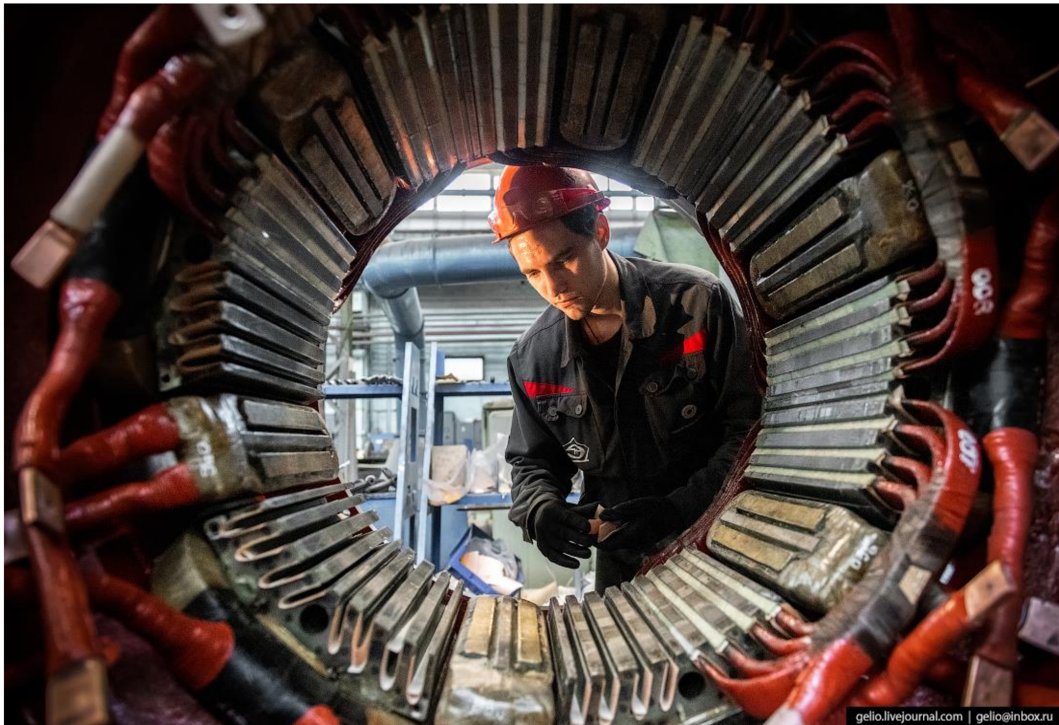
Готовые якоря, которые можно монтировать в электродвигатель
