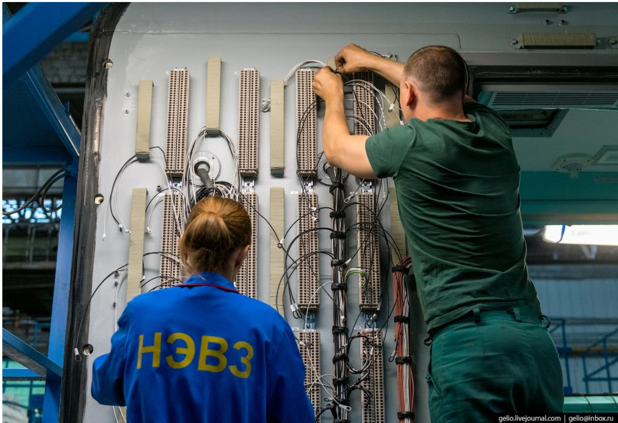
В заднюю стенку кабины электровоза монтируют электронику
