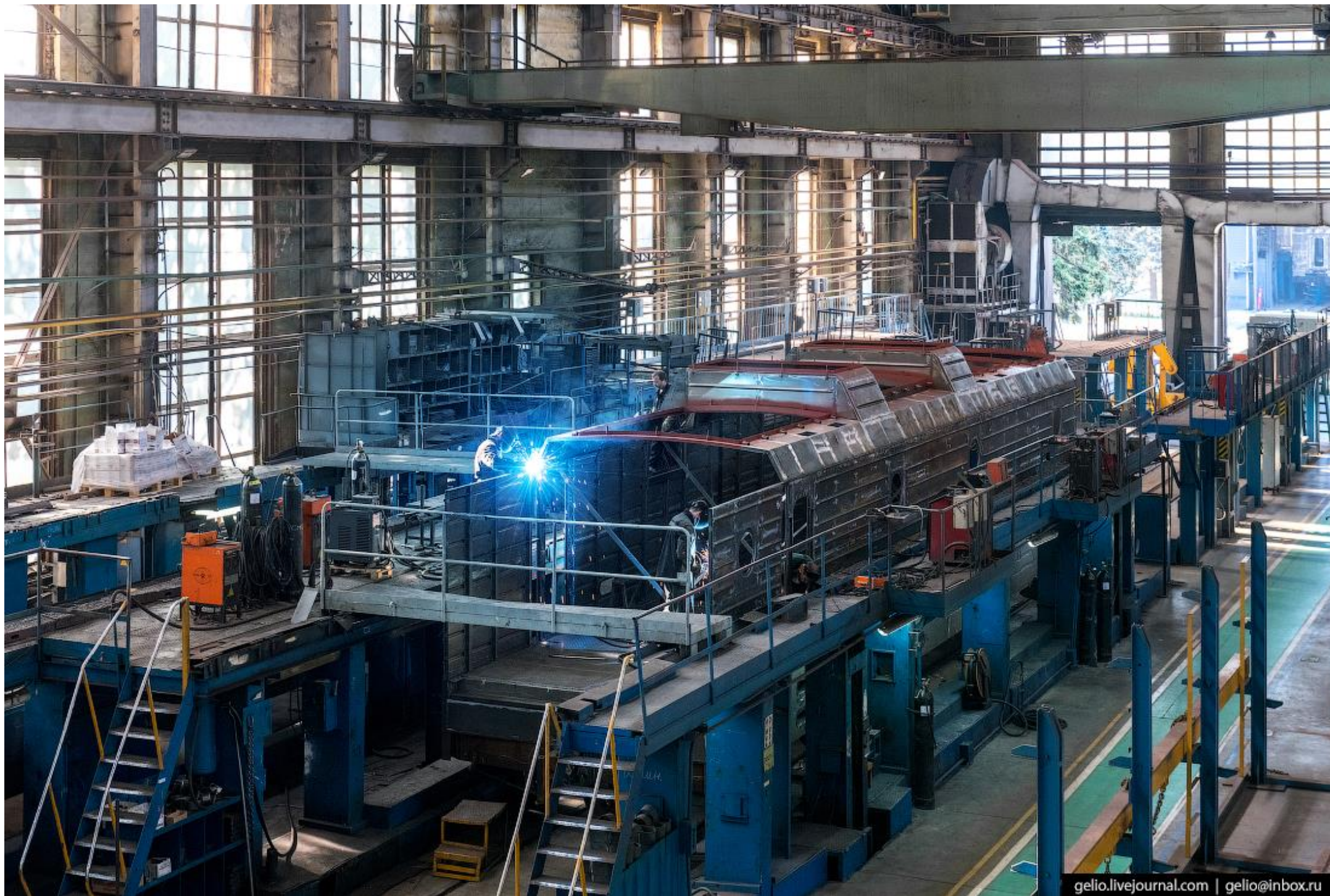
Крышу электровоза соединяют с боковой стенкой
